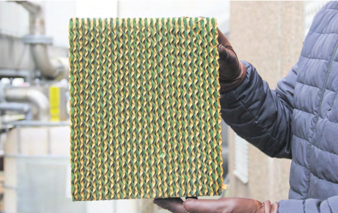
Hjärtat i processen är cellulosa-blocket där uppvärmt vatten på en stor yta exponeras för luft.
