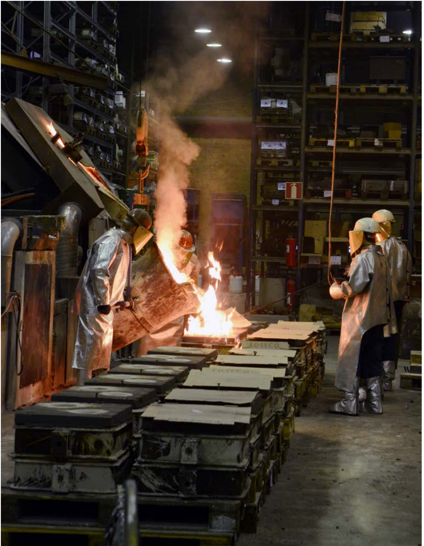
Avgjutning. Norrhults Stålgjuteri har två ugnar på 1,2 respektive 2 ton. Ugnarna kan köras parallellt.
