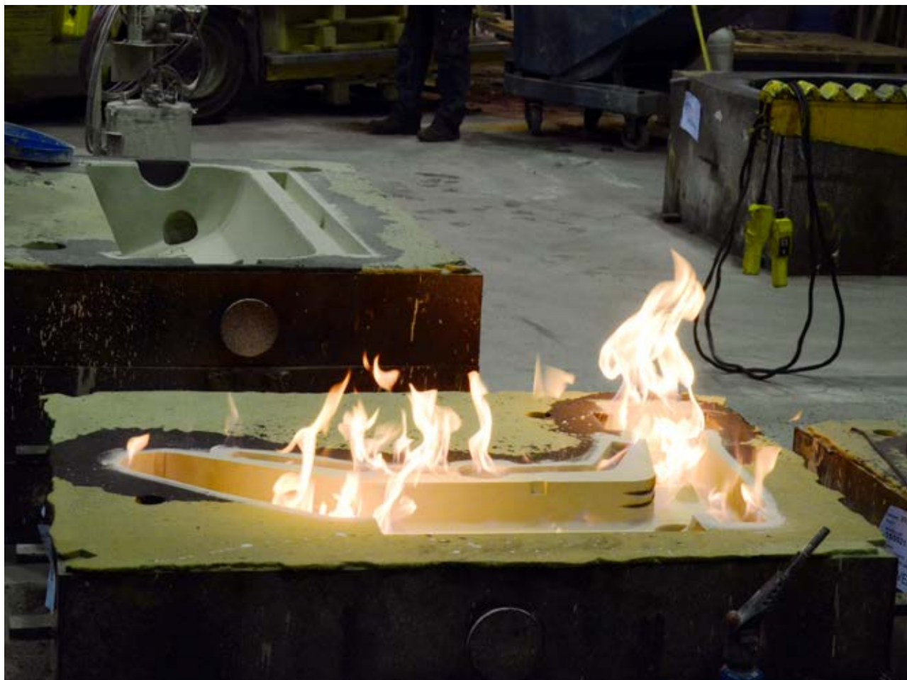
Bolaget använder endast vattenglas som bindemedel vilket kräver alkoholbaserad black som här bränns av.
