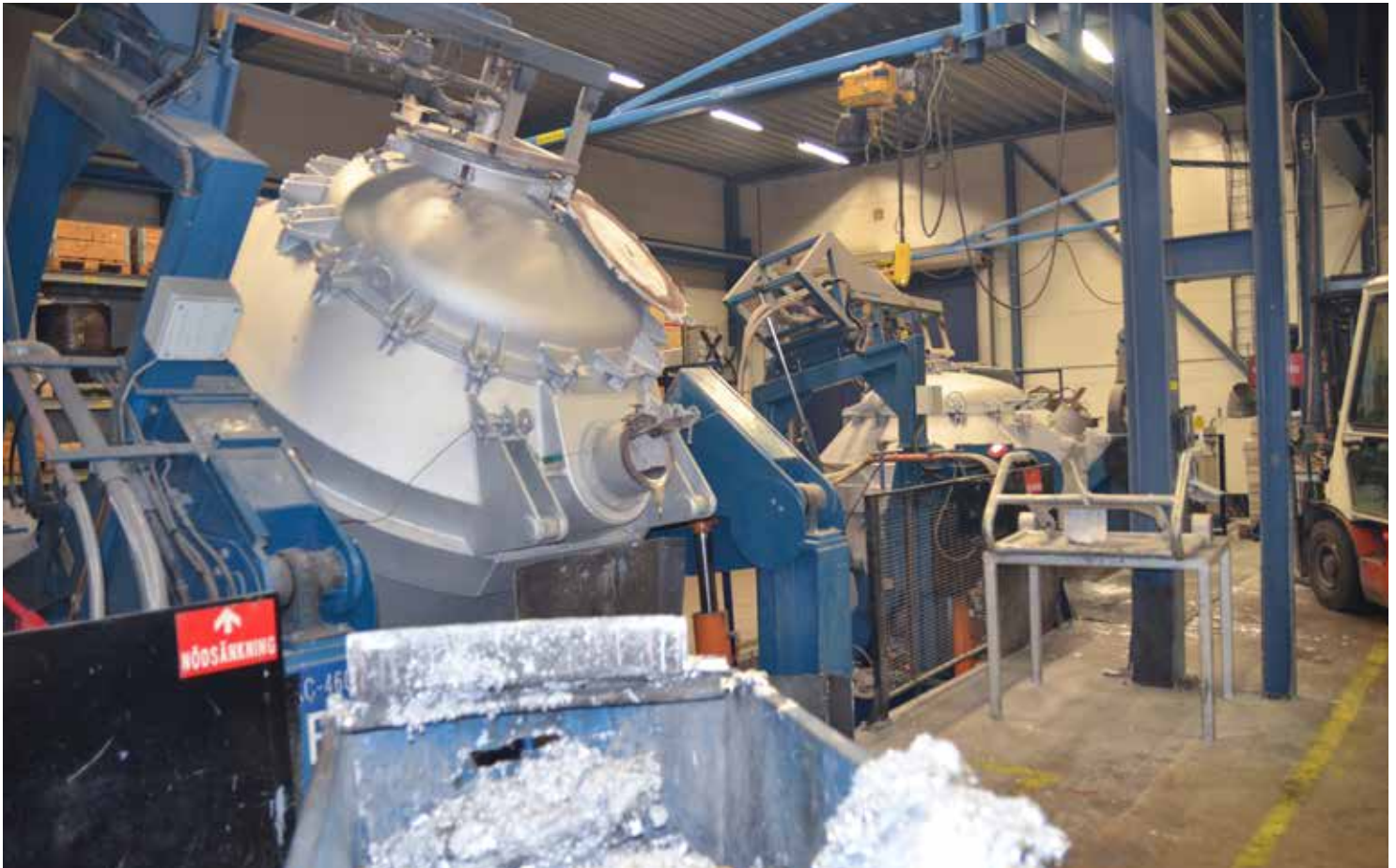
En del av aluminiumet kommer i smält form och förvaras i de här termosarna.
