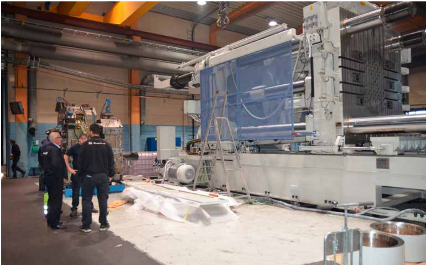
Ute i fabriken står en av flera nya investeringar, en gjutmaskin med 3700 ton i låskraft.
