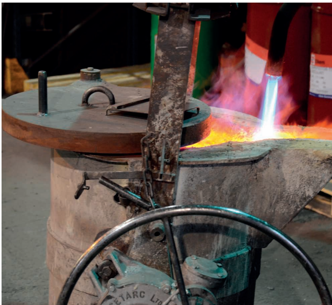
Vid gasolfövärmning av skänkarna används lock för att minska energiåtgången.
