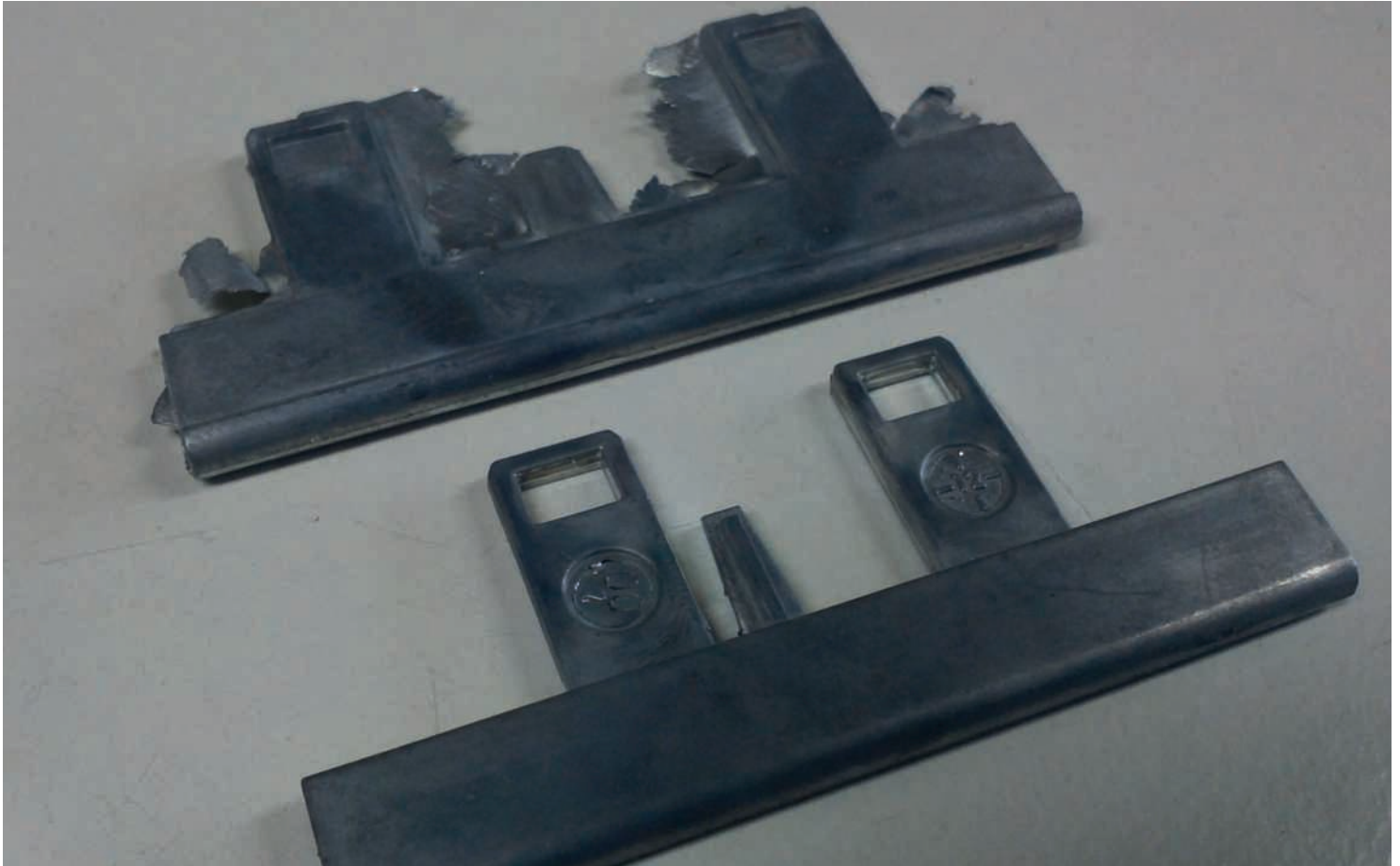
Pressgjutna zinkgjutgodsdelar, överst med grader och under utan. Vid avgradning med kväve djupkyls de tunna graderna snabbt och blir spröda. Genom en blästringsoperation med plastgranulat kan graderna lätt avlägsnas.
