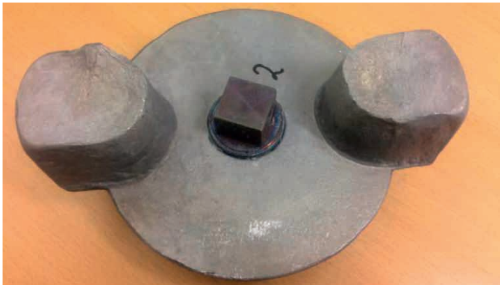
Den prototyp som utvecklats i projektet. I mitten syns den ingjutna stäldelen.
