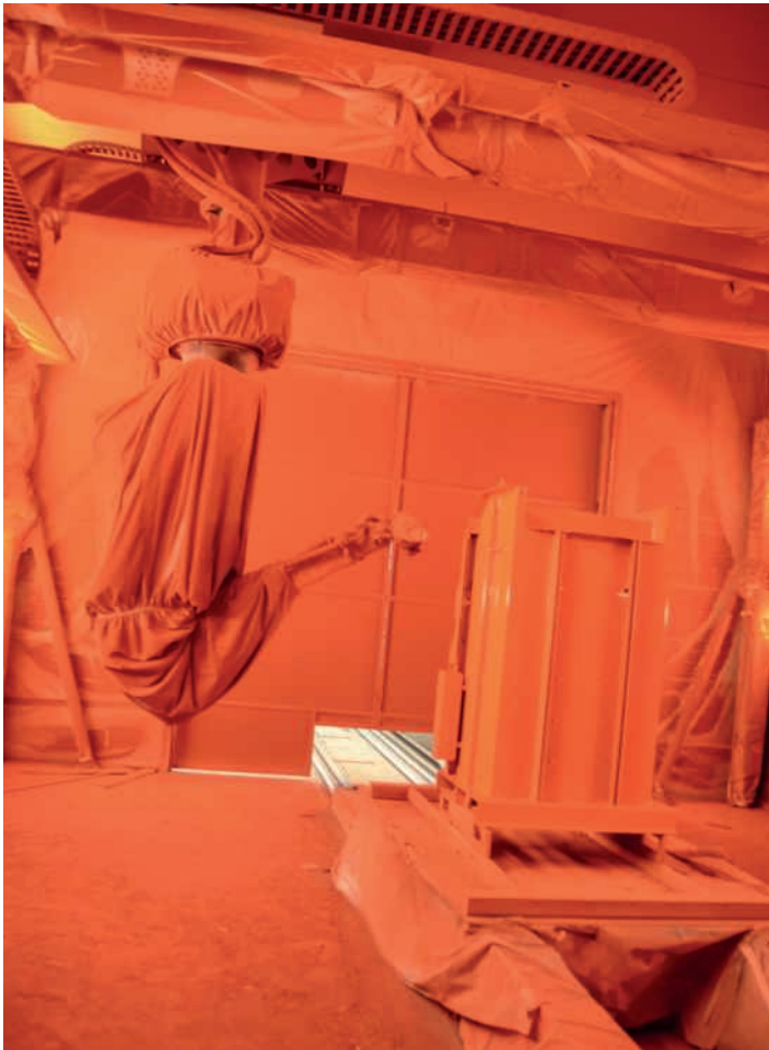
En robot våtlackerar ett plåtskåp. Mycket av Industriservice verksamhet är automatiserad.
